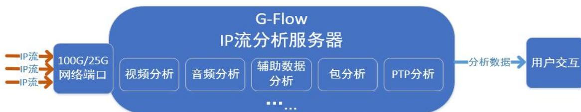
高性能服务器 + 高速网络适配器 + 媒体 IP 流分析服务引擎 + 上层用户交互
